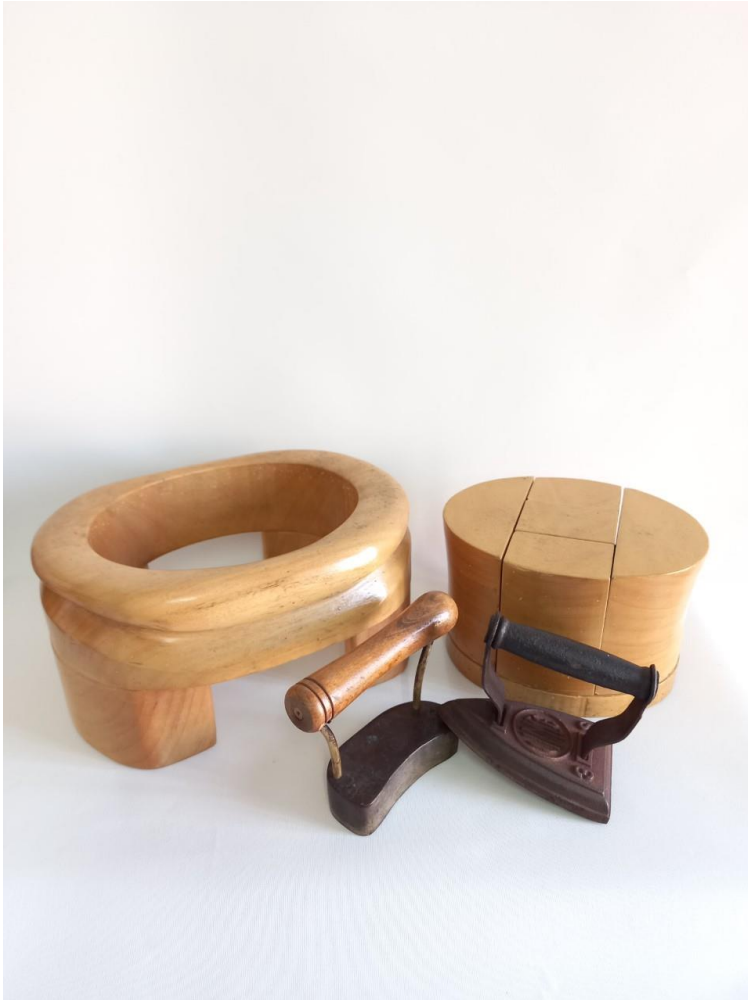
Herramientas para realizar la Chistera, horma de copa y ala. Planchas de hierro curva y plana
